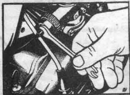
Obr. 13. Nastavenie bowdenu plynu
